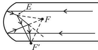
Em 1672 o astrônomo francês *Cassegrain* propôs a utilização de um espelho hiperbólico  $E$ , em lugar do espelho plano de Newton. Um dos focos da hipérbole coincide com o foco  $F$  da parábola.
