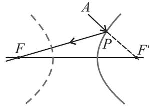
O telescópio refletor nada mais é do que um espelho parabólico no fundo de um tubo. Os raios provenientes de um corpo celeste distante (estrela, galáxia, planeta, etc.) formam um feixe praticamente paralelo, que se reflete no espelho e vai formar a imagem do objeto no foco  $F$ .
